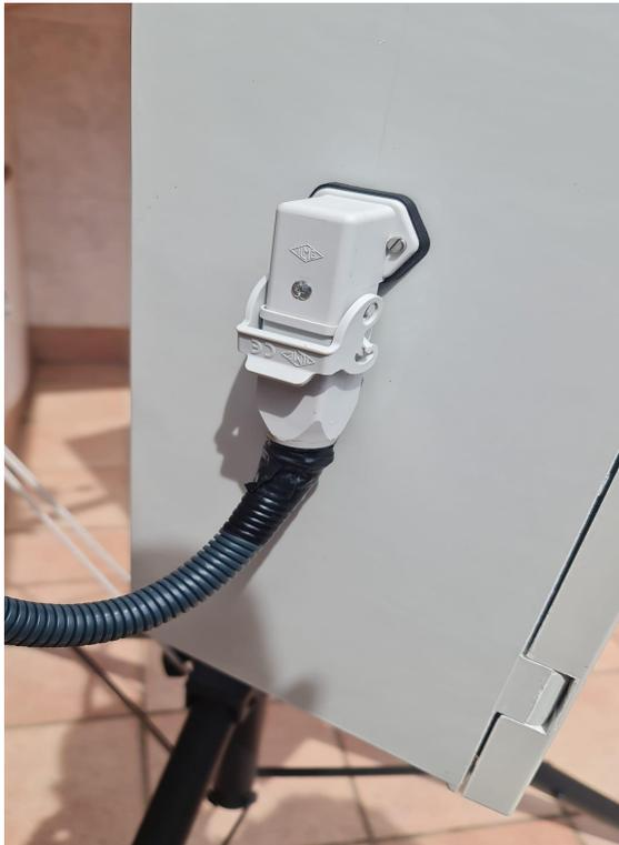
Figura 13. Detalle de la sujeción de los cables en uno de los laterales de la caja estanca.
