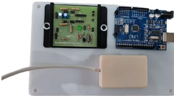
Figura 9. Detalle de la placa Arduino Uno R3 collada al soporte del *kit* electrónico.
