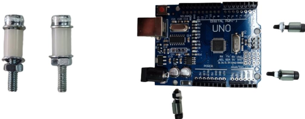
**Figura 7. Placa Arduino R3. a** | Detalle de la disposición de la tornillería que permite la sujeción del controlador Arduino Uno R3. Nótese que el tubo se coloca justo debajo de la misma para asegurar que no hay contacto alguno con las soldaduras ni el cableado. **b** | Disposición de la colocación de la tornillería que permite anclar la placa Arduino Uno R3 sobre la base de metacrilato.
