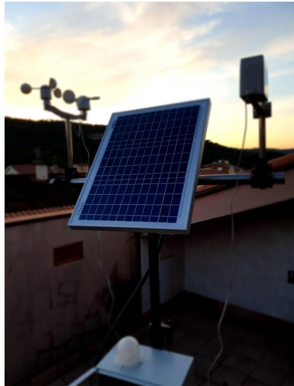
**Figura 16. Estación meteorológica.** Visión general de la estación montada y en pleno funcionamiento. a | Interior de la caja estanca donde se encuentra debidamente aislado la electrónica de la estación. Nótese que el teléfono móvil está sujetado en el interior de la
