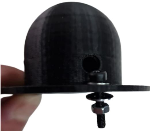
Figura 10. Detalle del montaje de la tornillería para sujetar la cúpula protectora debidamente en la caja estanca.
