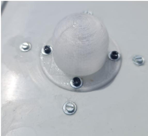
Figura 12. Detalle de la disposición de la cúpula protectora del sensor de luz sobre la parte superior de la caja estanca.
