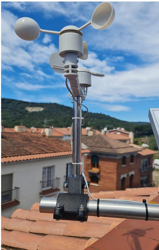
Figura 14. Visión de la veleta sujeta a la estructura de soporte. Nótese que la pieza negra que permite la sujeción se ha impreso mediante una impresora 3D.
